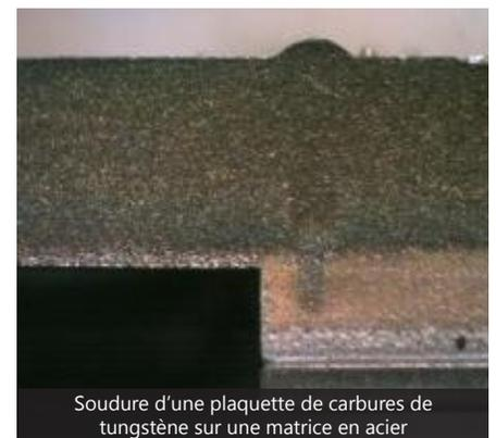
Soudure d'une plaquette de carbures de tungstène sur une matrice en acier
