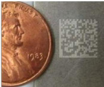
Code d'identification unique fait au laser sur une pièce d'aluminium (source : Industrial Laser Solutions)
