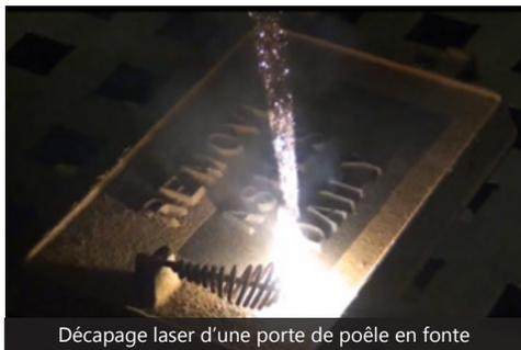
Décapage laser d'une porte de poêle en fonte
