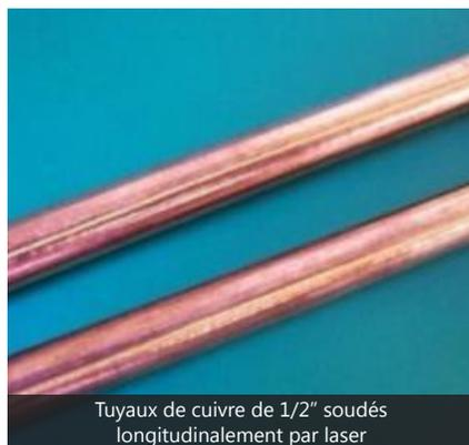
Tuyaux de cuivre de 1/2" soudés longitudinalement par laser
