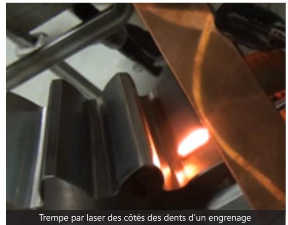
Trempe par laser des côtés des dents d'un engrenage
